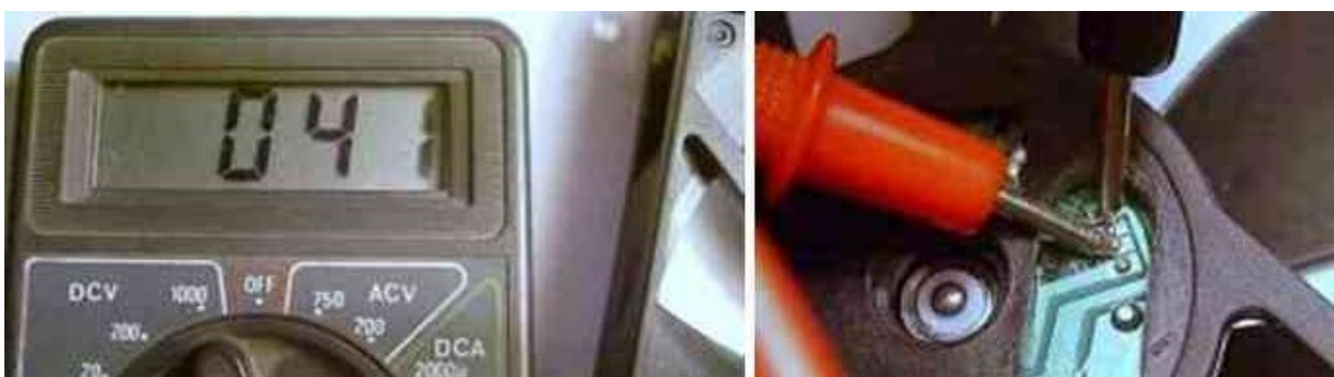
Рис. 4.2.2.1.3. Измерение сопротивления обмоток
