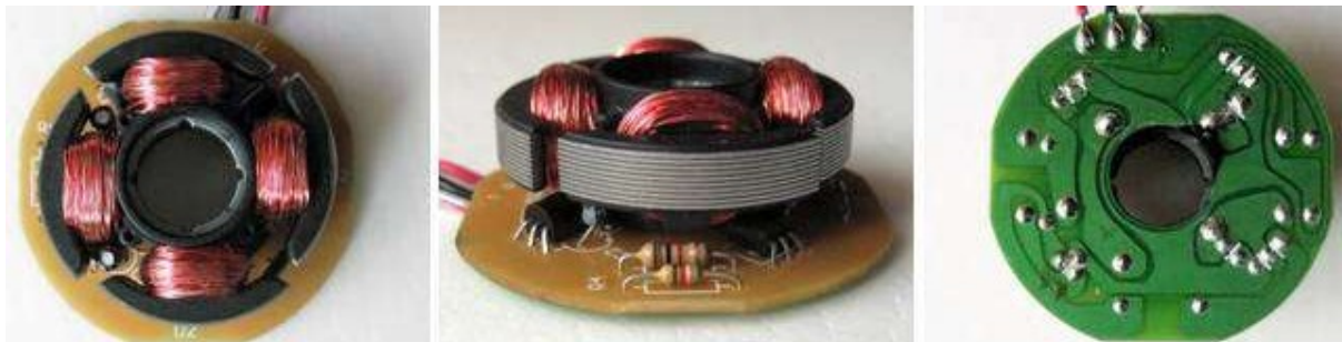
Рис. БЗ.1.2 Конструкция мотора вентилятора ZALMAN ZM-F3
