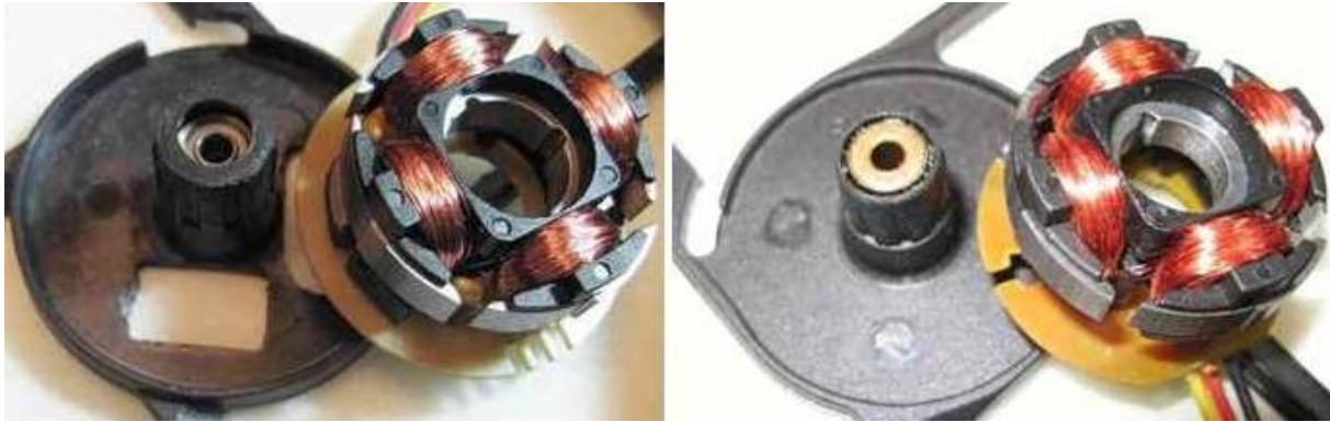
Рис. Б1.13 Подшипники (слева во втулке шарикоподшипник, справа - подшипник скольжения)
