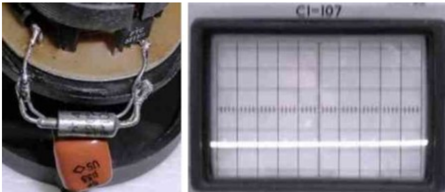
Рис. 4.1.7. Нормальная емкость блокировочного конденсатора
