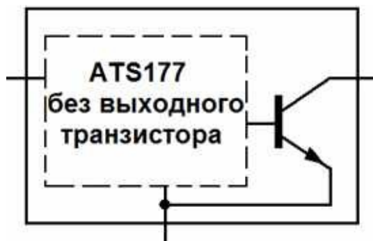
Рис. Б2.5 Транзистор по схеме с открытым коллектором в ИМС ATS177
