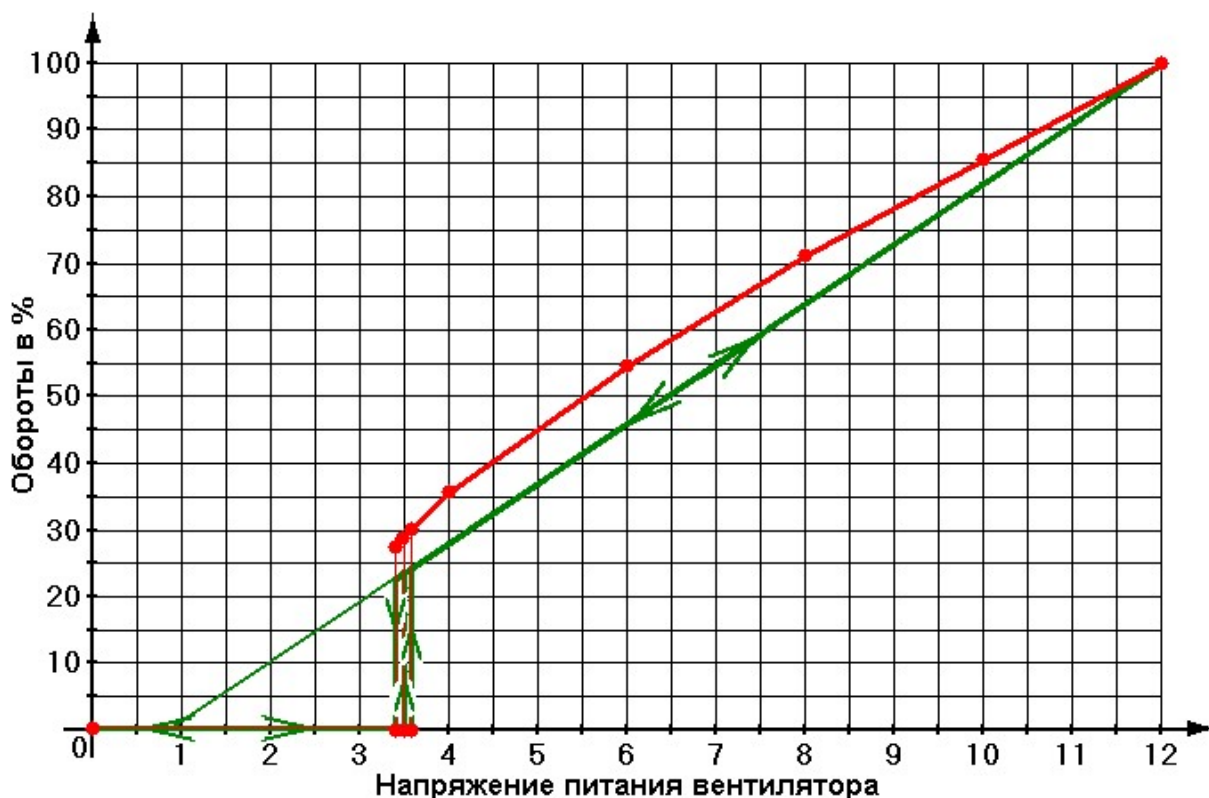
Рисунок 32 Зависимость скорости вращения вентилятора ZALMAN ZF1225ASN от напряжения питания
