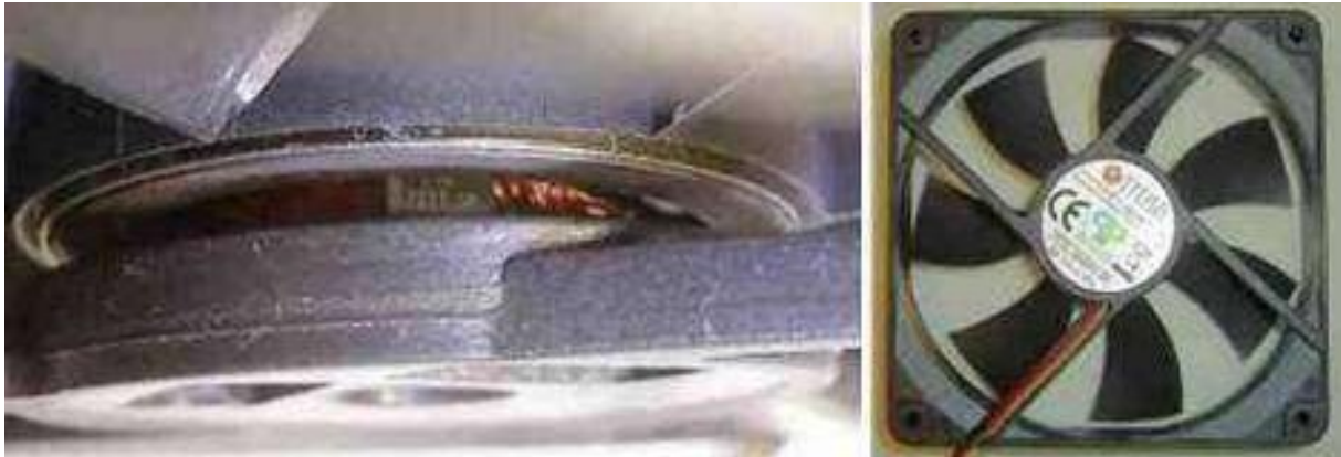
Рис. 4.2.2.1 Двухобмоточный мотор Titan TFD-12025M12B на ИМС ES211
