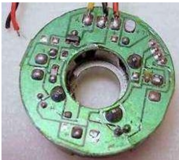
Рис. 4.3.1.1.4. Мотор с отсоединенными цепями подсветки
