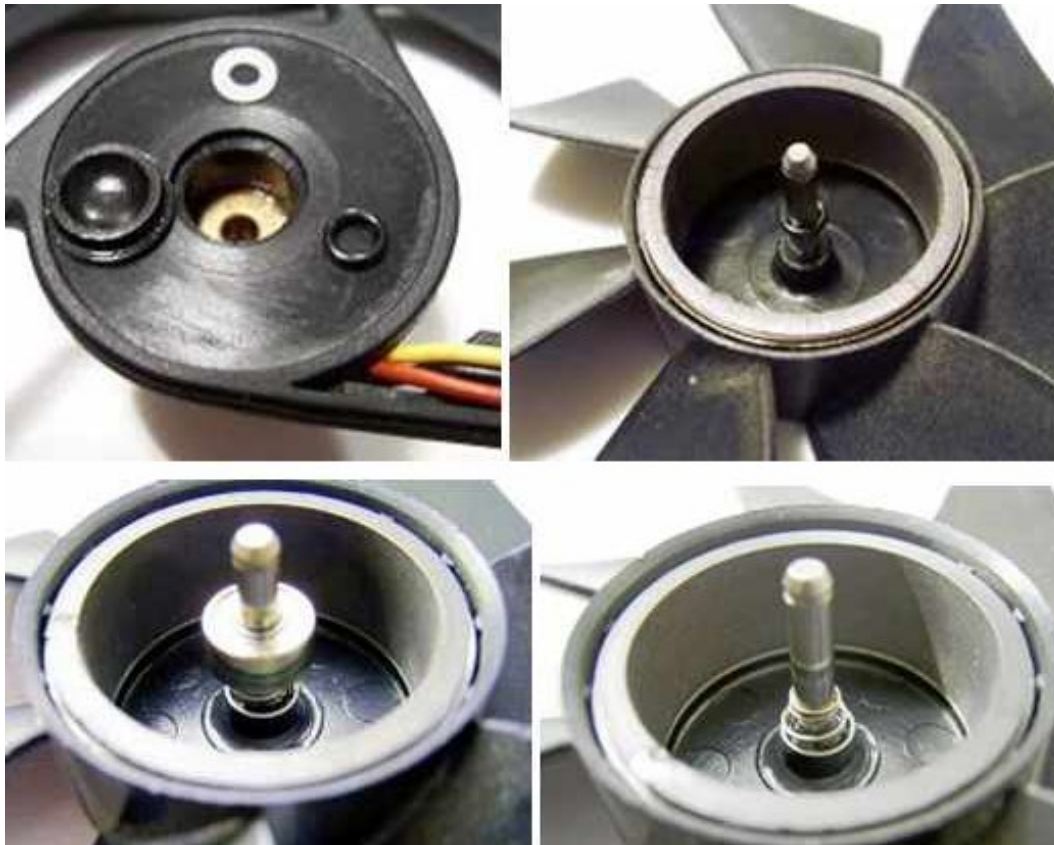
Рис. Б1.1.6 Снятые крыльчатки
