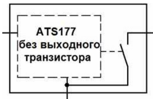
Рис. Б2.6 Представление выходного транзистора ИМС ATS177 в виде ключа
