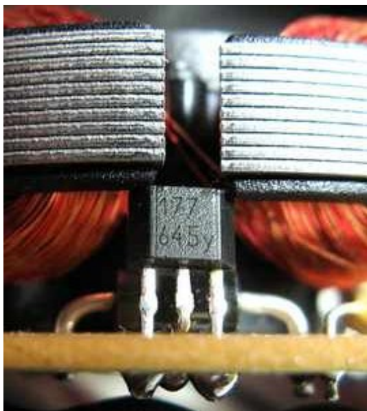
Рис. Б2.8 Положение ИМС ATS177 с датчиком Холла
