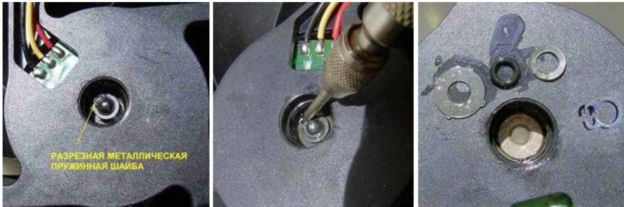
Рис. Б1.1.4 Снятие металлической разрезной шайбы
