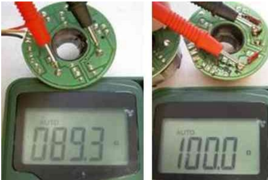
Рис. 4.2.1.1.12. Измерение сопротивления обмоток
