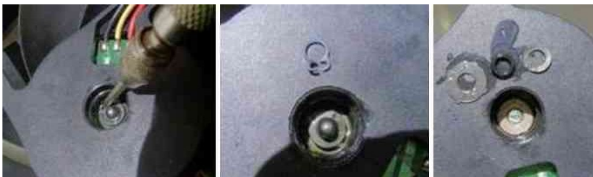
Рис. 4.2.1.1.5. Разборка крепления ротора нового мотора
