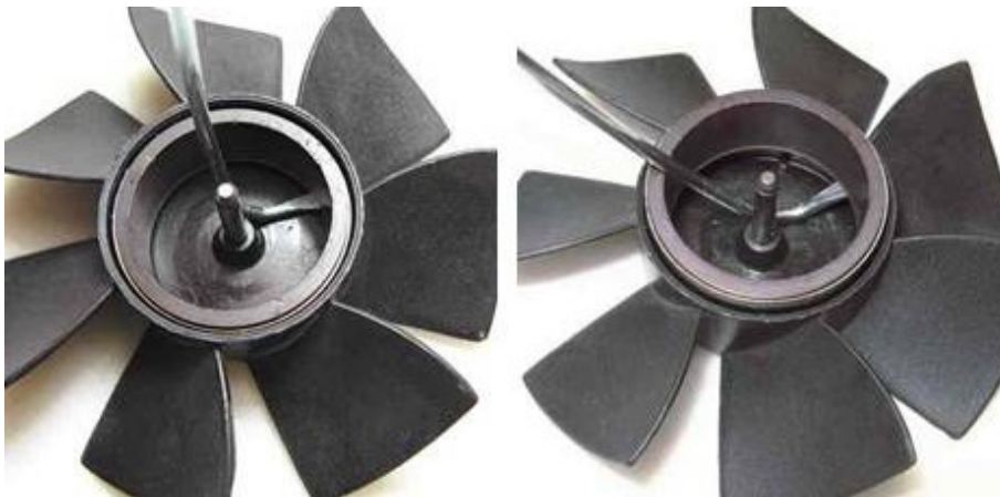
Рис. Б1.1.11 Использование приспособления для снятия магнита
