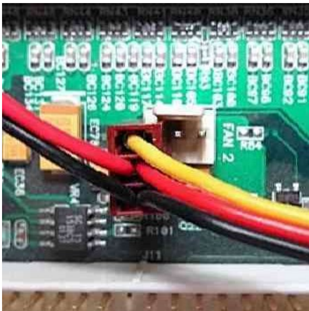
Рис. 3.2.2.1.7. Питание вентилятора от разъема Molex блока питания с использованием тахометра
