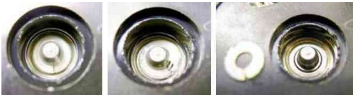
Рис. 4.2.1.1.6. Разборка крепления ротора старого мотора
