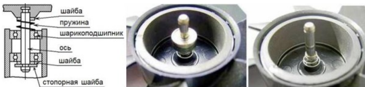
Рис. Б1.15 Крепление крыльчатки в вентиляторах с подшипником качения
