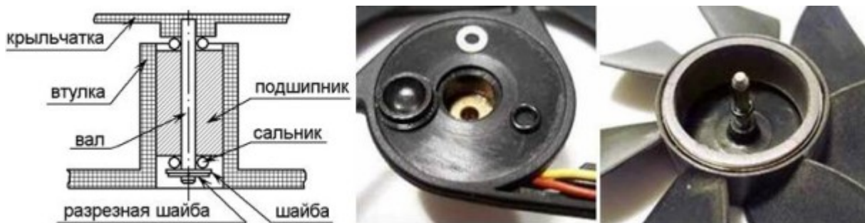
Рис. Б1.14 Крепление крыльчатки в вентиляторах с подшипником скольжения
