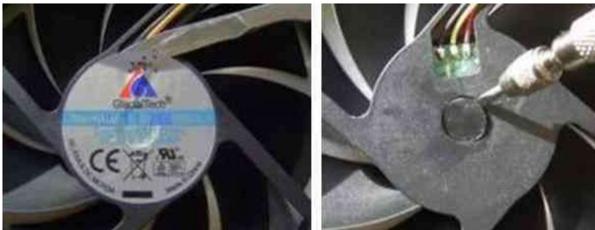
Рис. 4.2.1.1.3. Снятие этикетки и удаления пробки
