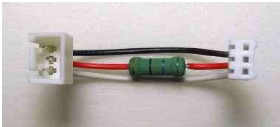
Рис. 3.2.2.2.7. Переходник идущий в комплекте с вентилятором ZALMAN ZM-F3
