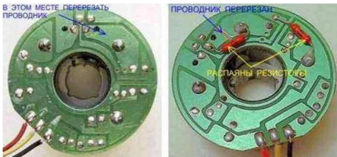
Рис. 4.2.1.1.14. Монтаж резисторов
