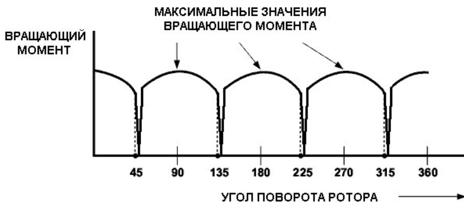
Рис. 2.3.3. Изменение вращающего момента в реальном моторе
