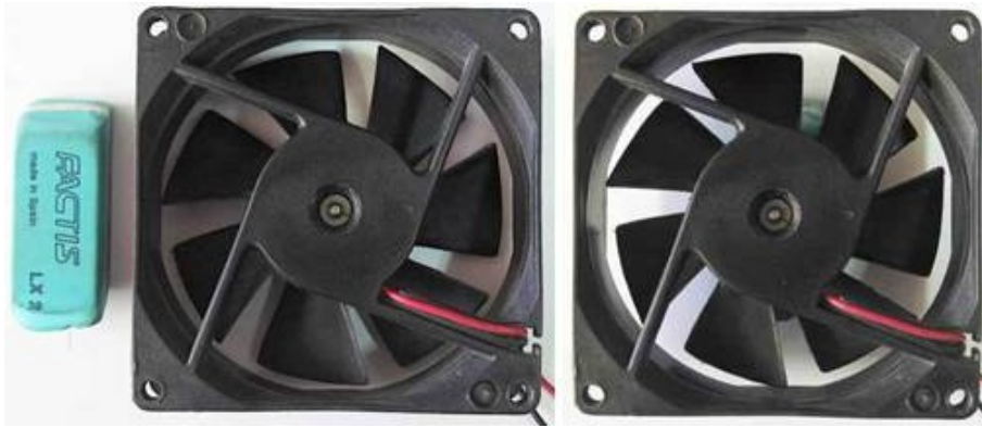
Рис. Б1.1.2 Стопорение крыльчатки
