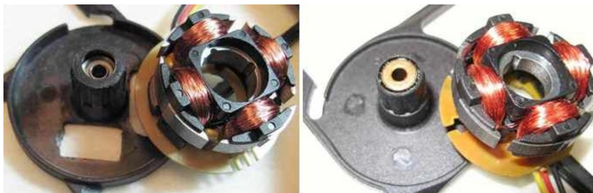
Рис. Б1.1.9 "Мотор" снят (слева во втулке шарикоподшипник, справа - подшипник скольжения)
