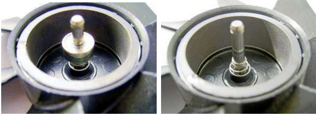
Рисунок 192 Снятие с оси крыльчатки подшипника и пружины
