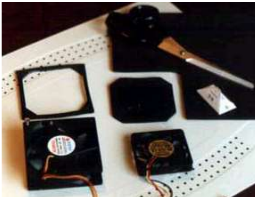
Рисунок 231 Самодельные вибропоглощающие прокладки
