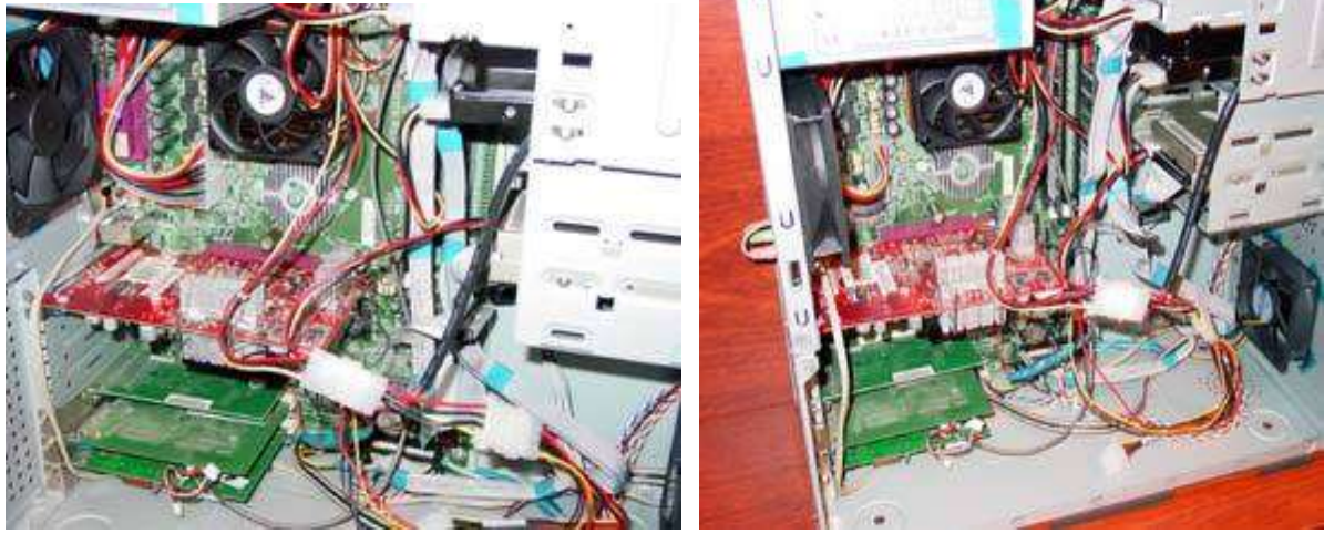
Рисунок 127 Укладка самодельных "аэродинамических" шлейфов
