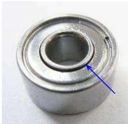
Рисунок 194 Место смазки подшипника качения
