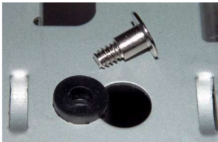
Рисунок 233 Крепление дисков с помощью резиновых шфйб в корпусе ASUS Ascot 6AR/300
