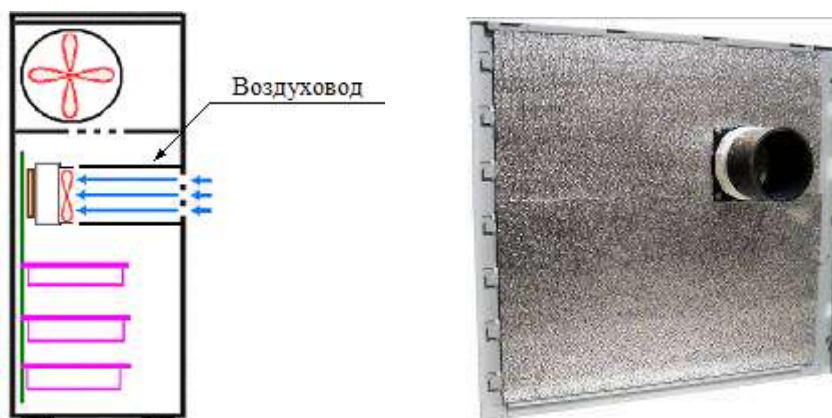
Рисунок 96 Корпус с воздуховодом на боковой крышке в зоне установки процессора
