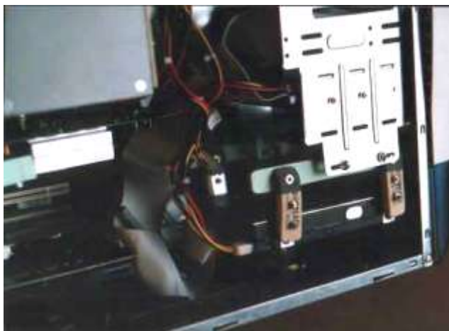
Рисунок 235 Подвешивание диска с помощью мягких канцелярских ластика
