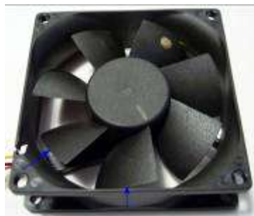
Рисунок 203 Место спливания материала лопастей
