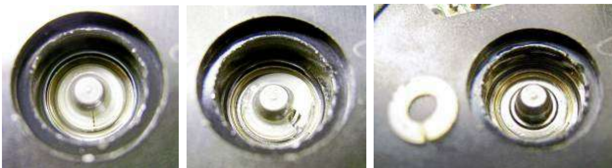
Рисунок 190 Снятие разрезной шайбы
