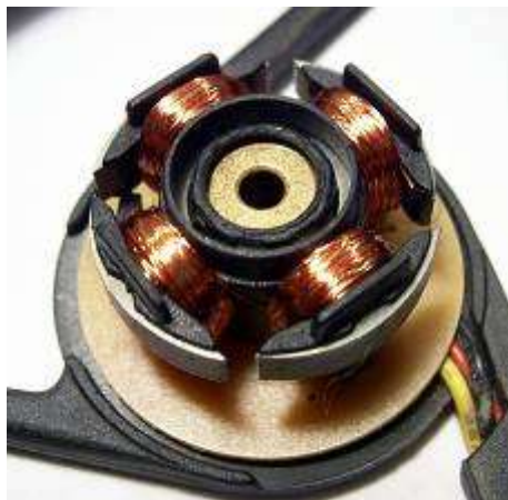
Рисунок 199 Бронзовая втулка подшипника скольжения
