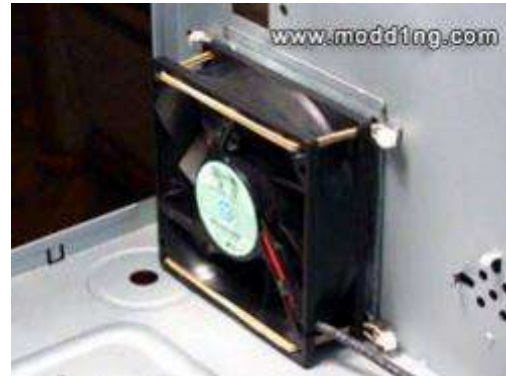
Рисунок 222 Мягкий подвес вентилятора на резиновых растяжках
