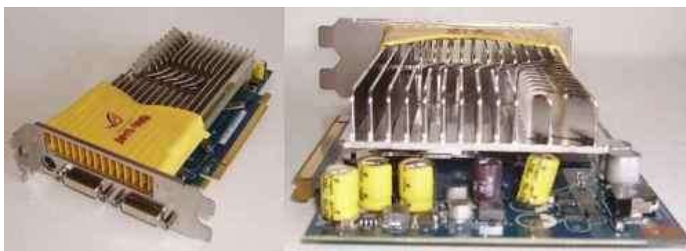
Рисунок 10 Видеокарта с охлаждением "заборным" воздухом
