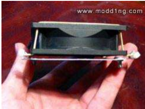
Рисунок 222 Мягкий подвес вентилятора на резиновых растяжках
