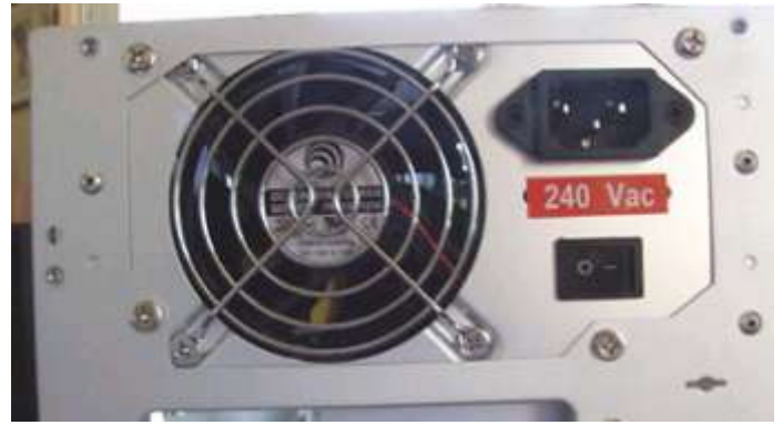
Рисунок 66 Препятствия на пути движения воздушного потока в корпусе без вентиляционной решетки в блоке питания
