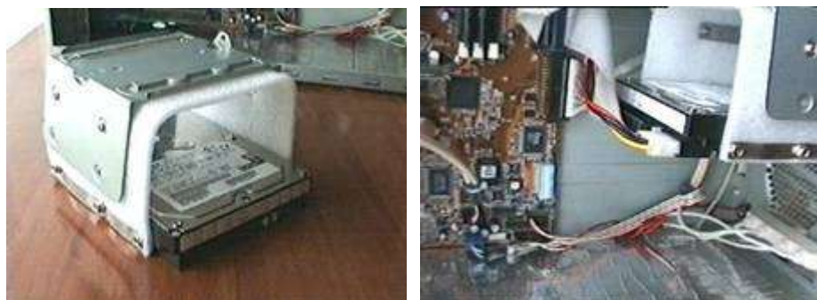
Рисунок 236 Подвешивание диска с помощью листового пенополиуретана
