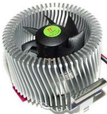
Рисунок 166 Неудобное и опасное крепление кулера Thermaltake Chrome Orb
