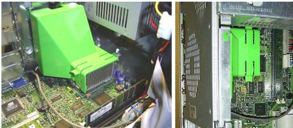
Рисунок 107 Жесткий пластмассовый воздуховод
