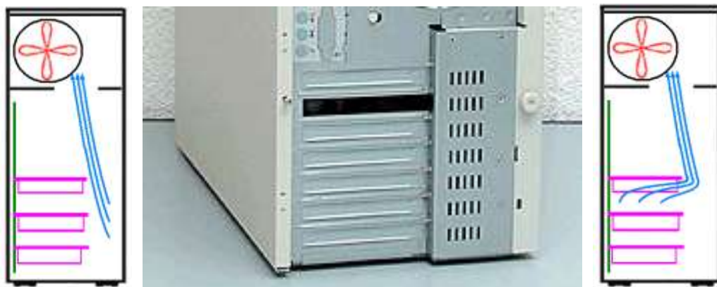
Рисунок 73 Отверстия в задней стенке корпуса, одна заглушка удалена
