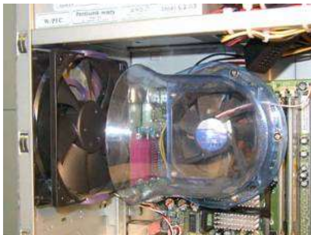
Рисунок 94 Охлаждение процесора в компьютерах Team X:SE фирмы Team Computers
