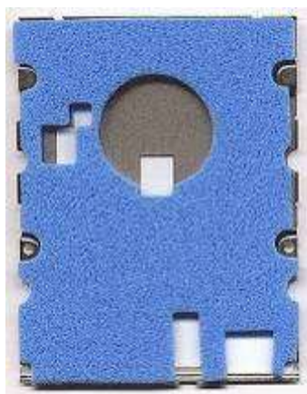
Рисунок 208 Защитная крышка дна жесткого диска Seagate Barracuda ATA IV
