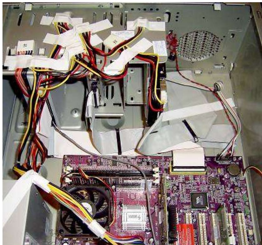
Рисунок 128 Примерная укладка жгутов и шлейфов в корпусе
