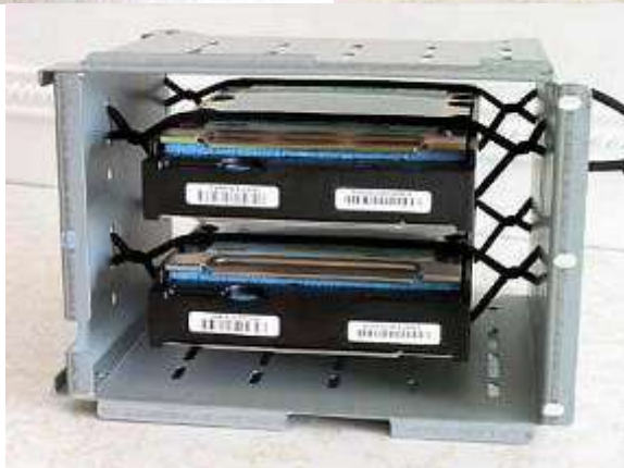
Рисунок 245 Подвешивание диска с помощью резинового шнура
