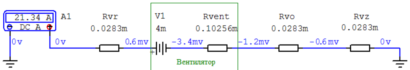
Рисунок 63 Эквивалентная схема воздушного потока в корпусе с одним вентилятором в блоке питания
