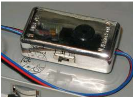
Рисунок 95 Регулятор оборотов вентилятора
