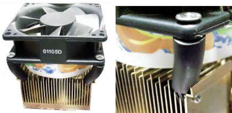
Рисунок 228 Мягкий подвес в кулере с сужающимся переходником
