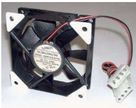
Рисунок 226 Четыре мягких уголка на клеящей основе – защита вентилятора от вибраций
