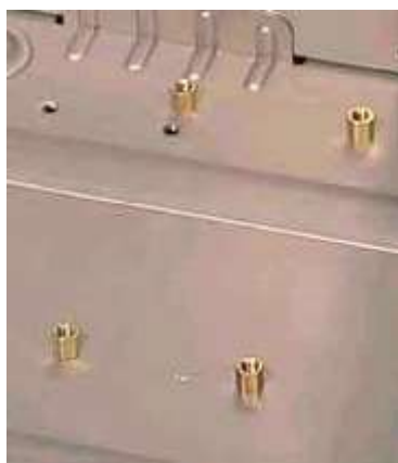
Рисунок 40 Крепление для тяжелого кулера процессора
