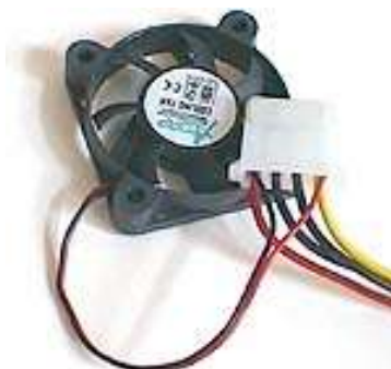
Рисунок 186 Питание вентилятора напряжением 7 Вольт
