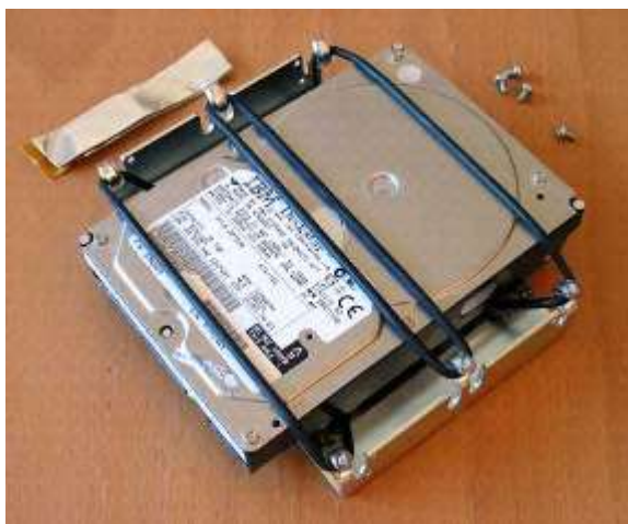
Рисунок 243 Подвешивание диска с помощью No-Vibes III
