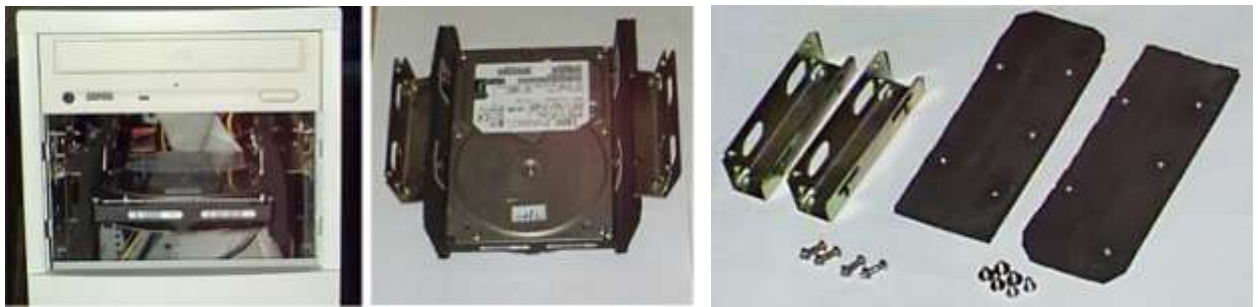
Рисунок 240 Установка жесткого диска в 5" слот
