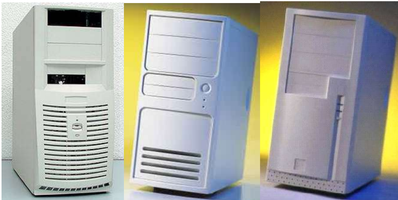
Рисунок 48 Вентиляционные отверстия на лицевой панели корпуса
