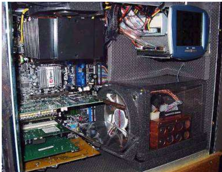
Рисунок 252 Пример тотальной оклейки корпуса
