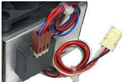
Рисунок 170 Устройство автоматической регулировки скорости вращения
