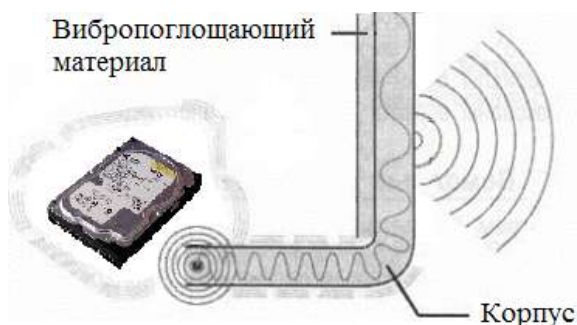
Рисунок 248 Снижение структурного шума с помощью вибропоглощающих материалов
