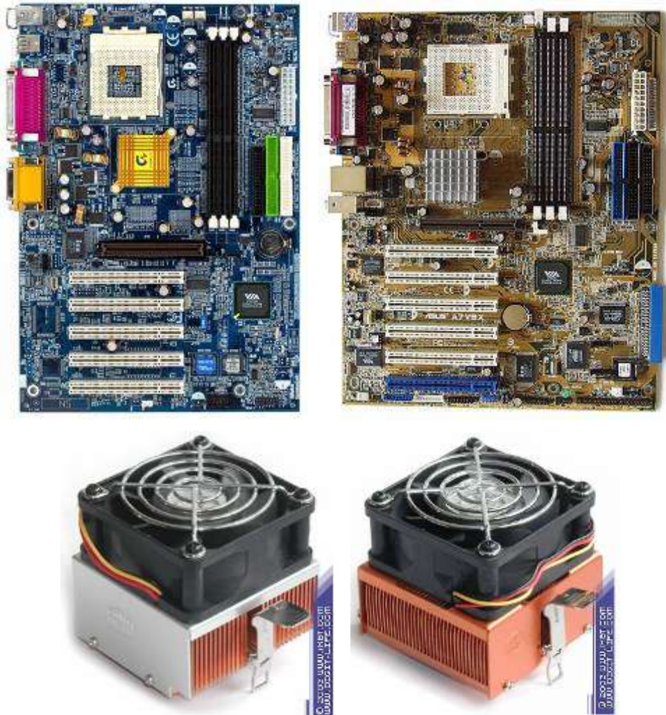
Рисунок 174 Совместимость конструктивных особенностей материнской платы и процессорного кулера
