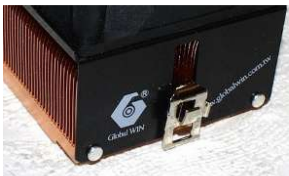
Рисунок 164 Клипса с защелкой на одну лапку с каждой стороны сокета и специальной скобой для отвертки
