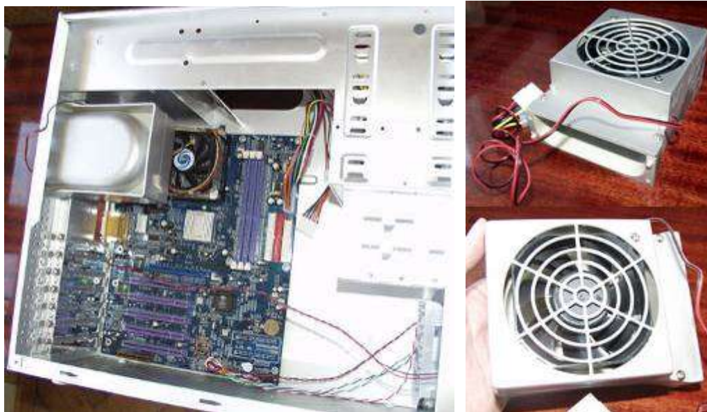
Рисунок 93 Алюминиевый корпус UTT Eagle 4378ETSL со встроенным блоувером
