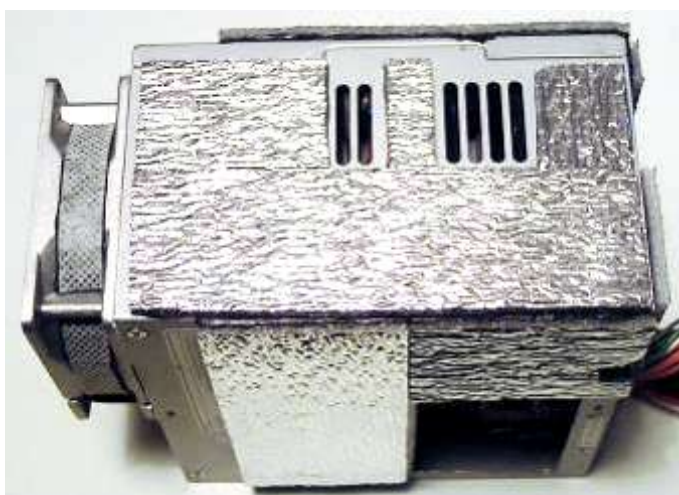
Рисунок 253 Оклейка блока питания
