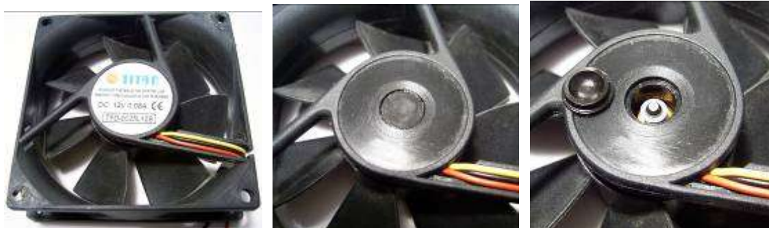
Рисунок 195 Снятие наклейки и пробки
