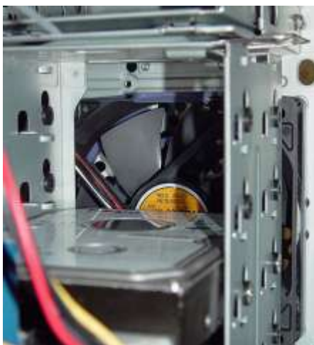
Рисунок 233 Крепление дисков с помощью резиновых шфйб в корпусе ASUS Ascot 6AR/300
