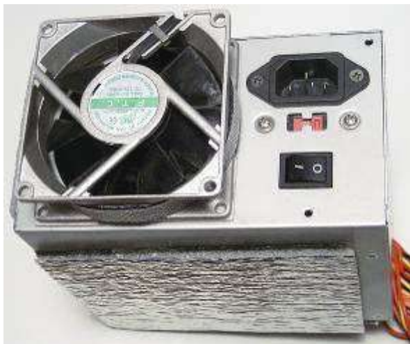
Рисунок 253 Оклейка блока питания
