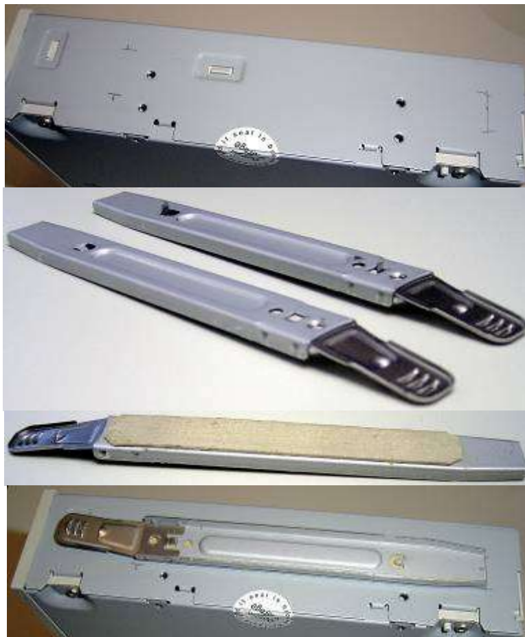
Рисунок 246 Крепление CD-ROM, DVD-ROM с помощью эластичной прокладки
