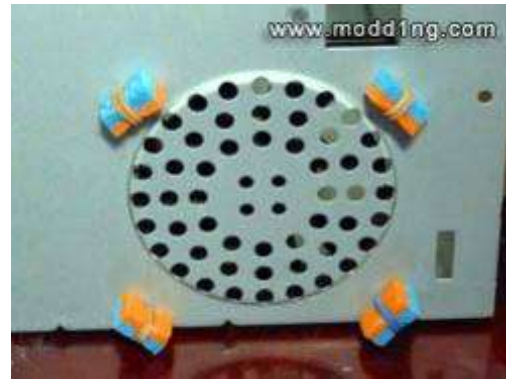
Рисунок 221 Мягкий подвес вентилятора на эластичных шайбах
