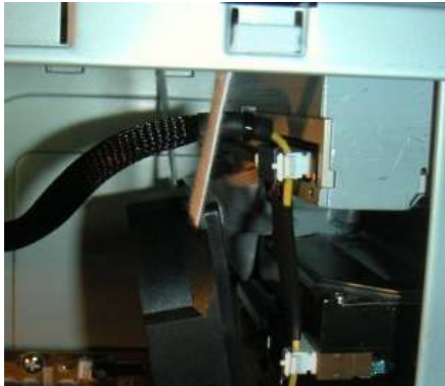
Рисунок 223 Мягкий подвес на бельевой резинке вентилятора обдувающего HDD
