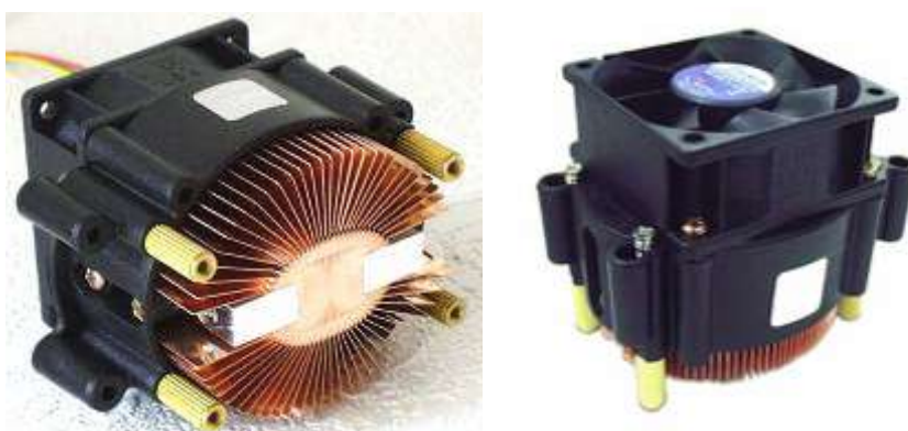
Рисунок 163 Zalman CNPS5100 — медный тяжелый кулер с креплением, совсем не зависящим от лапок
