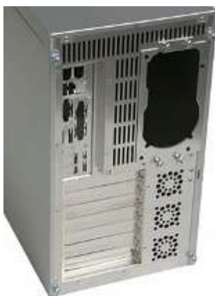
Рисунок 44 Посадочные места под вентиляторы размером 40 мм
