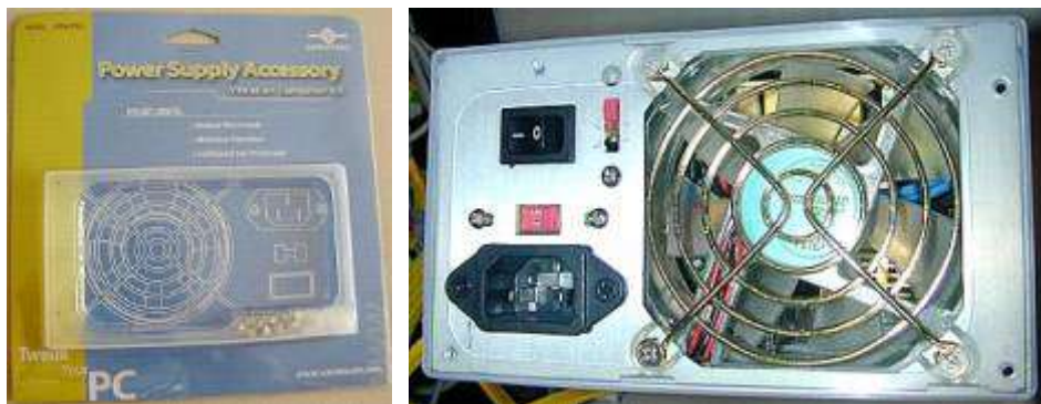
Рисунок 263 Демпфер вибраций для блока питания
