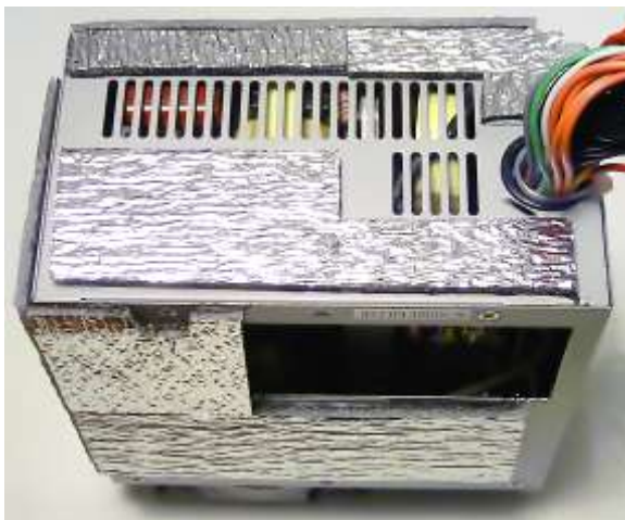
Рисунок 265 Оклейка корпуса блока питания виброизолирующими и шумопоглощающими материалами
