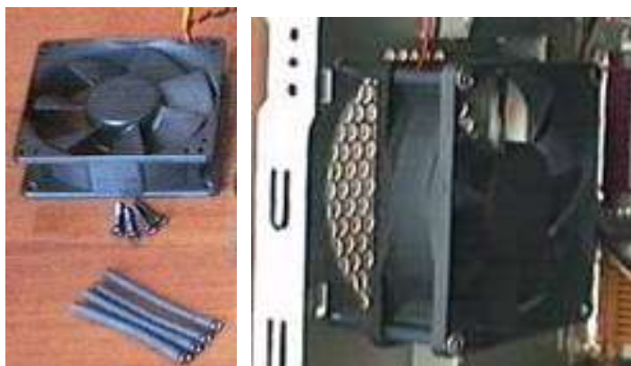
Рисунок 219 Мягкий подвес вентилятора на резиновых трубках-ножках
