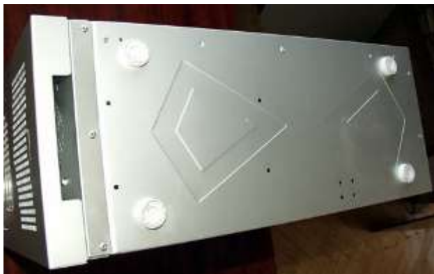
Рисунок 53 Вентиляционное отверстие снизу лицевой панели корпуса
