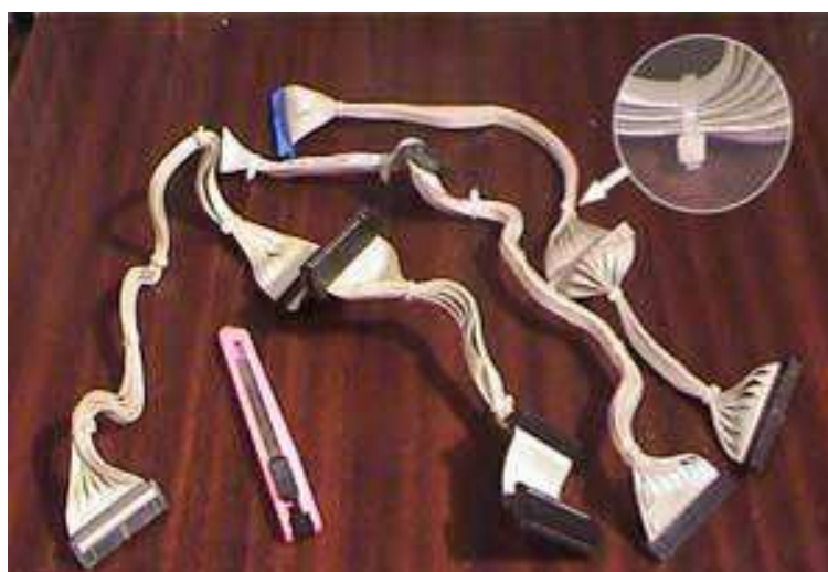
Рисунок 126 Самодельные разрезные "аэродинамические" шлейфы
