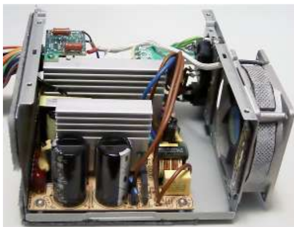
Рисунок 262 Блок питания с удаленной решеткой и вентилятором закрепленным снаружи
