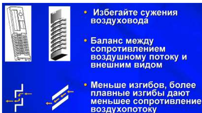
Рисунок 50 Требования к воздухозаборникам на лицевой панели корпуса
