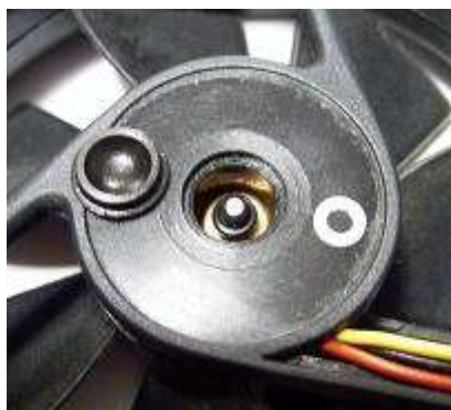
Рисунок 196 Резиновое колечко на валу крыльчатки
