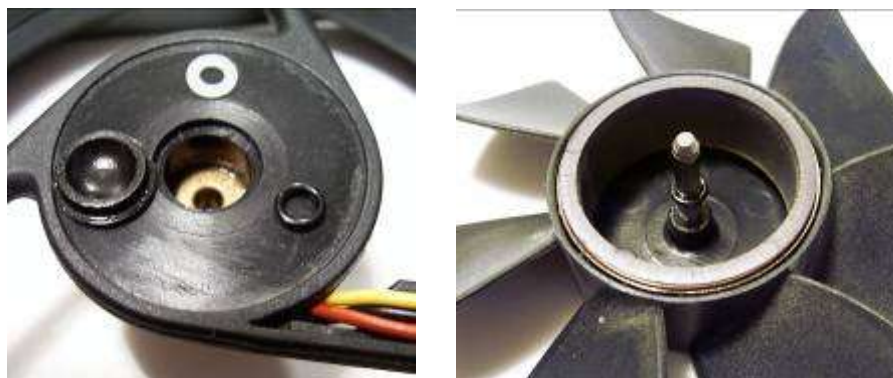
Рисунок 198 Снятие резиновых колечек
