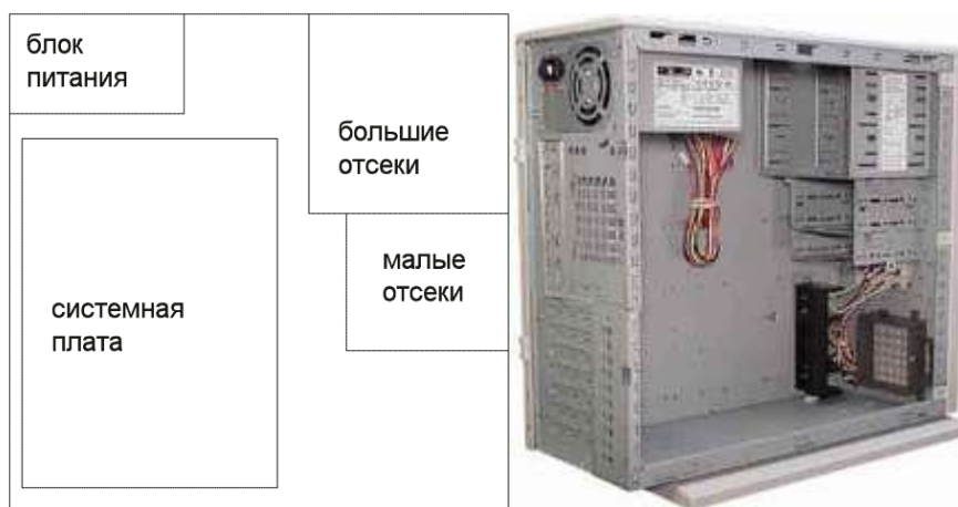
Рисунок 38 Расположение блока питания в корпусе "без перекрытия"
