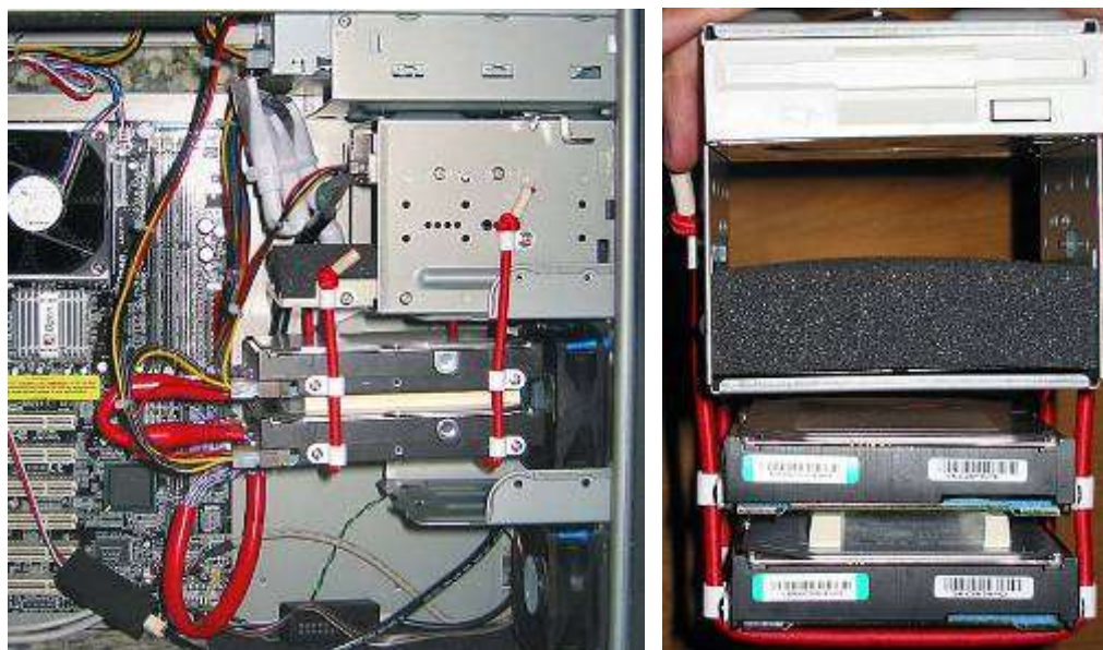
Рисунок 238 Подвешивание диска с помощью резинового шнура
